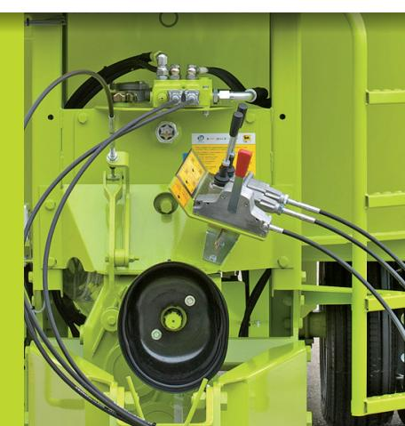
2-biegowa przekładnia, także z mechanicznym sterowaniem linką zkabiny ciągnika (opcja).
