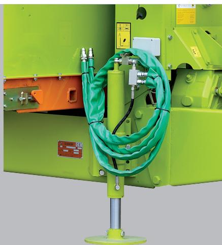
Hydrauliczna podpora połączona z hydrauliką i sterowaniem ciągnika
