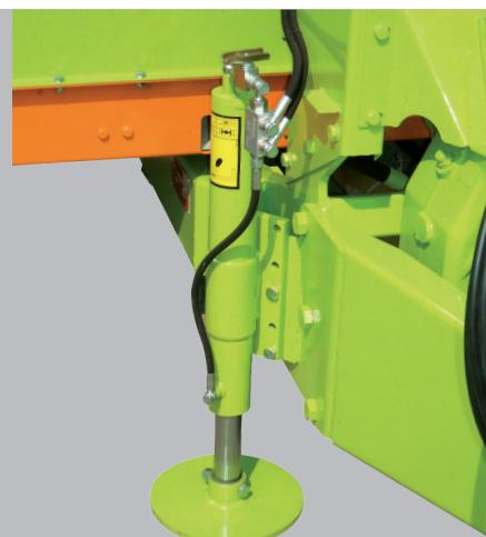
Hydrauliczna podpora połączona z hydrauliką i sterowaniem wozu paszowego
