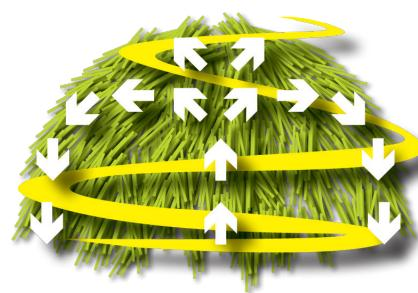
Na rysunku widać wznoszenie i opadanie produktów wewnętrz zbiornika, co zapewnia szybkie i skuteczne cięcie wszystkich składników.
