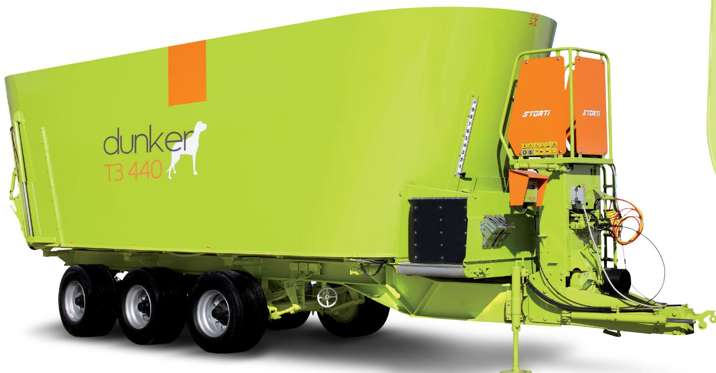
6 pojedynczych kół 435/50 R19.5 na standardowym samosterującym wózku trzyosiowym z resorami piórowymi z samosterującą osią pierwszą i trzecią oraz blokowaniem podczas biegu wstecznego
