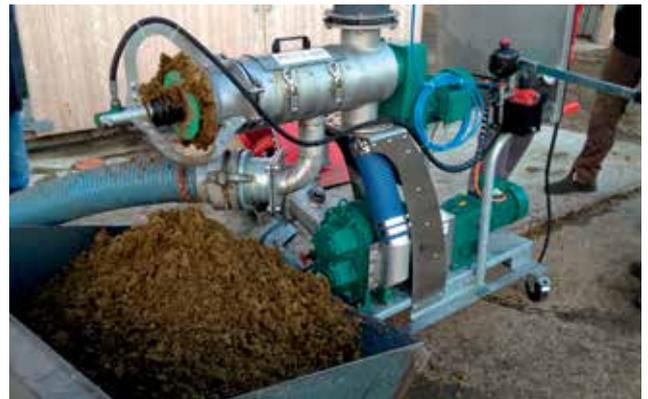
Мобильный сепаратор в резервуаре | Separacja mobilna w zbiorniku
