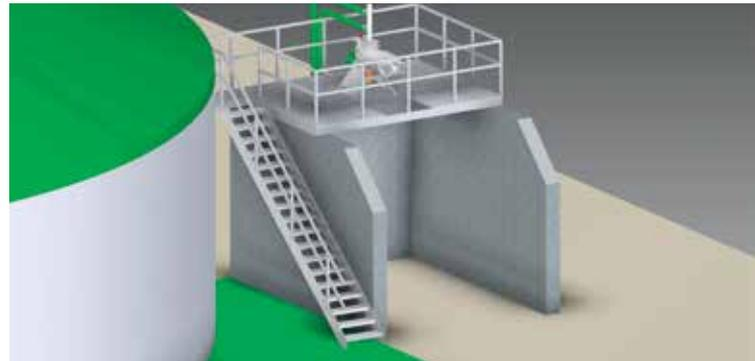
Сепаратор на бетонном помосте с системой перелива. Separator na podeście betonowym z systemem przelewowym.
