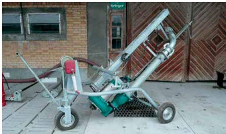
Тележка Trioport с насосом TMP в сложенном состоянии | Trio-Port z pompą zatapiałną w położeniu transportowym
